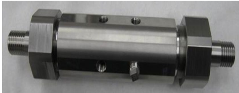
Рисунок 1 – Пристрій для динамічного змішування і гомогенізації палива і паливних емульсій
