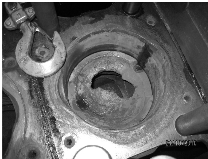
Рисунок 1 – Пошкодження поршня циліндра дизеля 6ЧН 18/22-25
