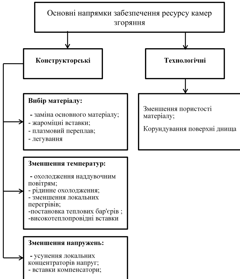
Рисунок 2 – Основні напрями підвищення довговічності деталей камери згоряння [1]
